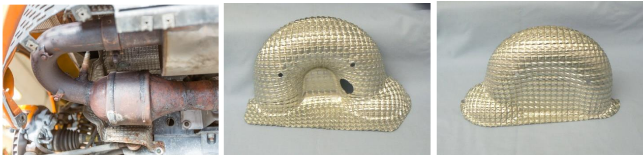
Den del af udstødningen hvor der ikke er varmeskjold – samt de to dele (top og bund) til det nye varmeskjold som monteres.
